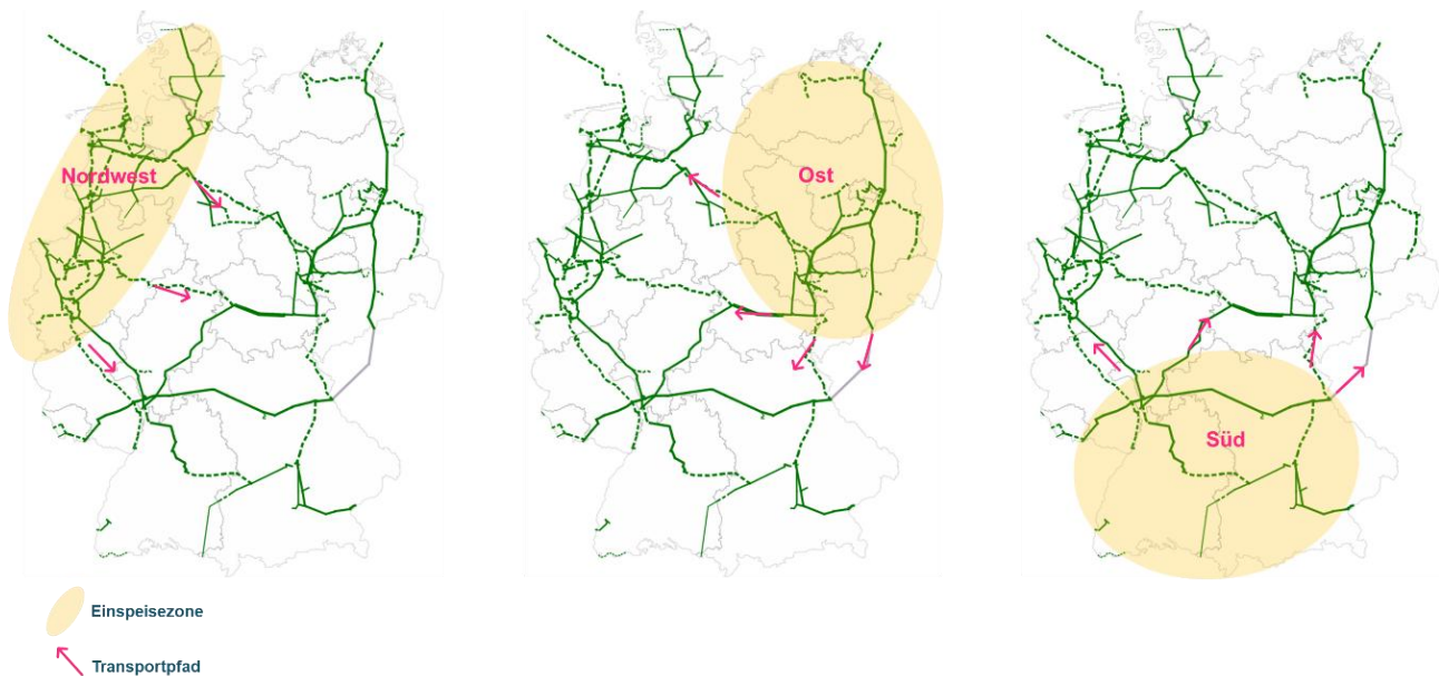
Abbildung 49: Einteilung der Einspeisezonen anhand identifizierter hochbelasteter Transportpfade in Regionen (schematische Darstellung)
